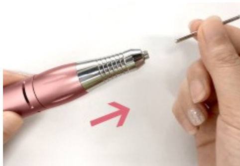
Krok 2: Wyciągnij oryginalne puste wiertło i wyjmij je
