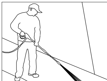
Rys. 6 – Optymalny kąt do czyszczenia powierzchni
